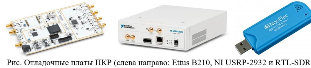
Рис. Отладочные платы ПКР (слева направо: Ettus B210, NI USRP-2932 и RTL-SDR)
